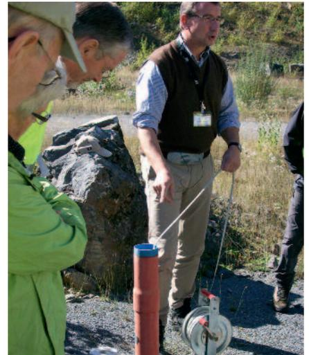
Dem Trink- und Grundwasserschutz kommt bei der Firma Westkalk eine große Bedeutung zu. Schon aus Eigennutz ist es wichtig zu wissen, wie hoch der Grundwasserspiegel ist. Denn man möchte den Kalkstein ja nicht im Wasser aufladen und transportieren. Das wäre auch für Westkalk der Super-GAU! Auf dem obigen Bild führt Dr. Mausbach eine Kontrolle des Grundwasserspiegels durch, die an diesem Tag ergab, daß das Grundwasser ca. 6 m unterhalb dieser Stelle stand. 2 m dürfen es höchstens sein.
