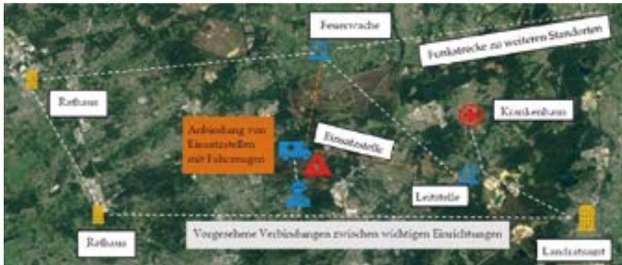
Abbildung 2: Ein typisches WiBACK-Netz im Katastrophenschutz. (Quelle der Karte: GoogleMaps)
