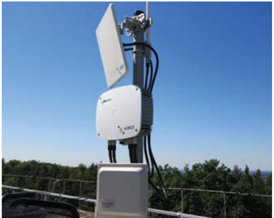
Dieser spezifische Aufbau besteht aus einem „WiBACK“-Knoten, zwei Richtfunk-Antennen (5 GHz) und einer Stab-Antenne für „LoRa“ Sensorik (IoT).
