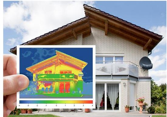
Wenn man sich vorher einen Überblick über den Zustand der Gebäudehülle des Hauses verschaffen möchte, ist eine Wärmebildaufnahme mit einer Wärmebildkamera hilfreich. Mit Hilfe der Wärmebildaufnahme wird die Qualität von Fassade, Dach, Fenster und Türen von außen sichtbar und die energetischen Schwachstellen sind gut erkennbar.
