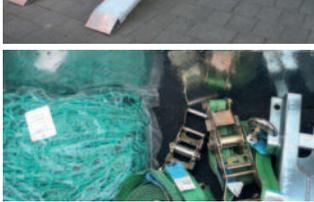
Der Anhänger hat folgendes Zubehör: 2 ALU-Auffahrampen mit 200 cm Länge und einer Breite von 22 cm. In der abschließbaren Deichselbox befinden sich z.B. Zurrgurte zur Ladungssicherung, ein Ladungssicherungsnetz und ein Kastenschloß für den Kuppelungskopf zur Sicherung gegen Diebstahl. Fotos: Mertens
