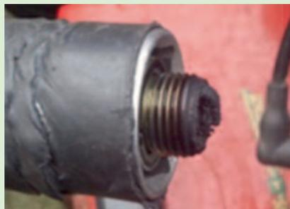
werden (dieses Kerzenbild tritt auf wenn z.B. der Mäher immer nur kurz betrieben wird). Der Motor springt damit schlecht an und läuft unruhig. Die Zündkerze äußerlich mit einer Drahtbürste, die Innenflächen mit 120er Schleifpapier, vorsichtig von den Belägen befreien und den Elektrodenabstand kontrollieren, 0,75 mm ist genau richtig, ansonsten ganz vorsichtig auseinander biegen bzw. enger klopfen.
