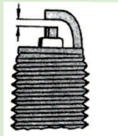
Falls Ihre Zündkerze abgebrannt (runde Elektrodenenden) oder anderweitig defekt ist, ersetzen Sie sie grundsätzlich immer durch das gleiche Modell (Aufschrift) bzw. Austauschartikel nach Vergleichstabelle. Falsche Zündkerzen können den Motor vollständig zerstören! (Dabei ist die Gewindegröße längst nicht das Einzige was passen muss!!)
