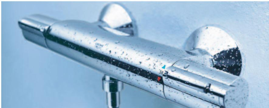
Hier stellen sie per Hand am linken Regler die Wassermenge und am rechten Regler die Temperatur ein. Die Thermostatkartusche mischt sekundenschnell die gewünschte Temperatur und hält diese konstant gleich.
