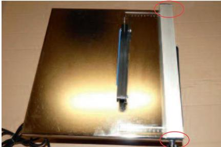
Der Anschlag wird vorn und hinten per Schraube fixiert, so dass nichts verrutschen kann.
