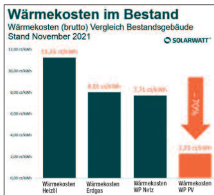
Grafik 3: Moderate Annahmen: Ölpreis: 90 ct/l, Gaspreis: 6,47 ct/kWh (aktuell stark steigend, Wirkungsgrad: 80%, WP-Strom: 27 ct/kWh Netzstrom: 30 ct/kWh (Greenpeace Energy), PV-Strom: 8 ct/kWh, JAZ: 3,5.
