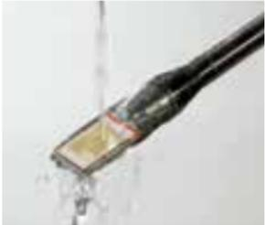
Gerät mit milden Spül-/Reinigungsmitteln reinigen. Sensor unter fließendem Wasser abspülen und mit einem weichen Papiertuch vorsichtig abtrocknen.
