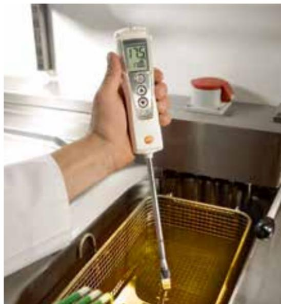
Abb. 12: Messung des TPM-Wertes in Frittieröl mit dem testo 270
