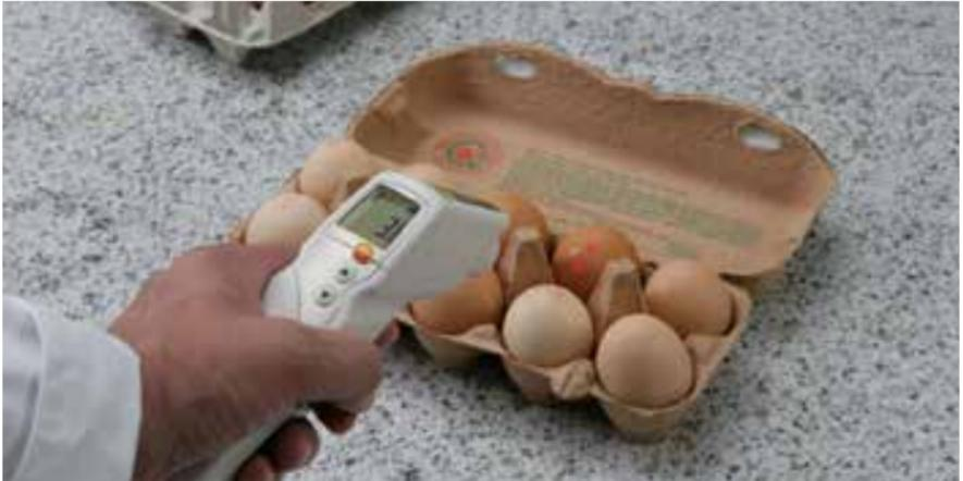
Abb. 5: Infrarot-Messung der Oberflächentemperatur an Nahrungsmitteln
