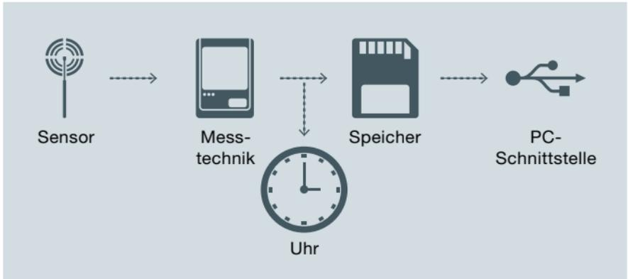
Abb. 6: Funktionsweise eines Datenloggers
