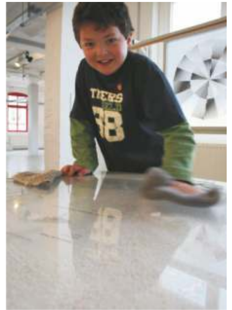
Lars reibt fleißig mit dem Lappen auf der Plexiglasscheibe – und lädt so die Styroporkugeln darunter elektrostatisch auf, die deshalb anfangen zu schweben
